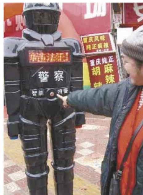
ских. Пока что они представляют собой стационарную установку, ведущую наблюдение за определенной территорией. Кроме этой функции в них также заложена возможность оперативного вызова наряда полиции и автономная система сигнализации. Двухметровые роботы, судя по отчетам, действительно помогают бороться с преступностью, предотвращая совершение преступлений.
